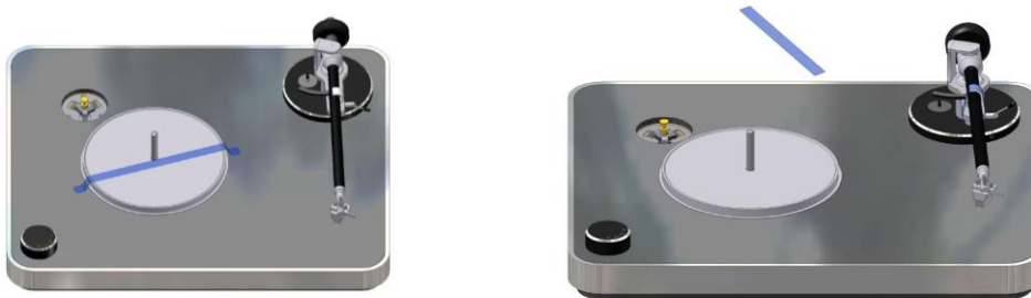
Abb. 2: Entfernen des Sicherheitsstreifens
